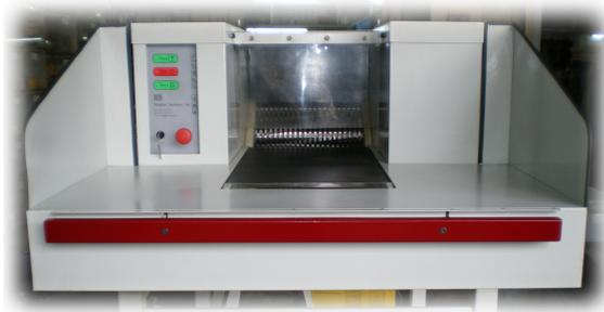
當遇有突發事需要急停機器運作，可將紅色驚示桿向前推即可殺停機器。在正常機器運作下，驚示推桿 Bar 應在抽起狀態。
